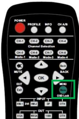
2. 出力解像度の設定を行います。OSD メニューの Image Properties > Output Mode から任意の解像度を選択します。
