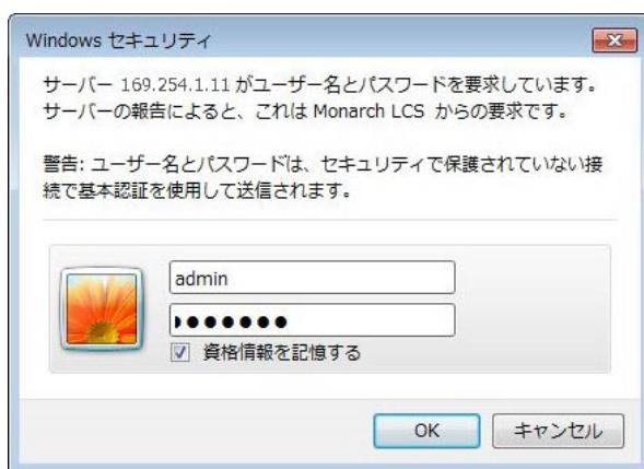
※ Monarch LCSに設定されているデフォルトIPアドレスは、コンピューターとMonarch LCSを直接接続して、初期設定を行うために割り当てられたアドレスです。デフォルトIPアドレスを変更せずにネットワークに接続して運用することは推奨しません。Monarch LCSを固定IPアドレスで運用する場合は、コマンドセンターから接続するネットワークに対応したIPアドレスを割り当ててください。
