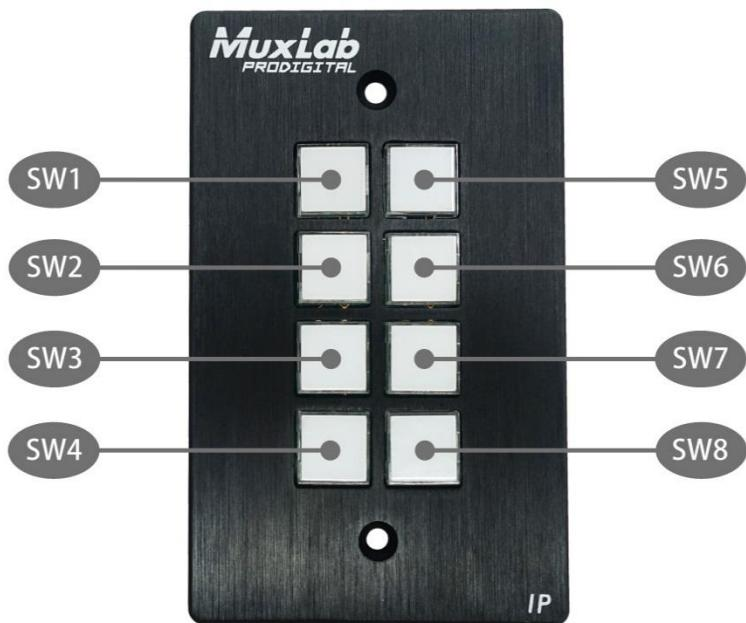
全てのボタンは TCP/IP、Telnet、RS232、IR、リレーに対応する端末機器を制御するようにプログラムできます。各ボタンに取り外し可能な透明プラスチックカバーがあり、ラベルを取り付けることが出来ます。
