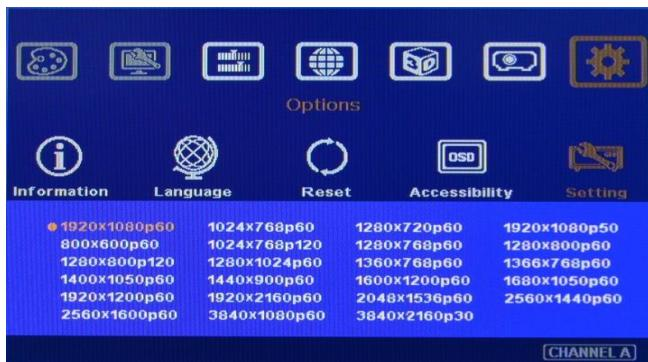
※ソース機器の GPU 仕様や機能制限がある場合、設定した EDID が反映されないことがあります。その場合、ソース機器側の解像度設定で任意の解像度を選択してください。
