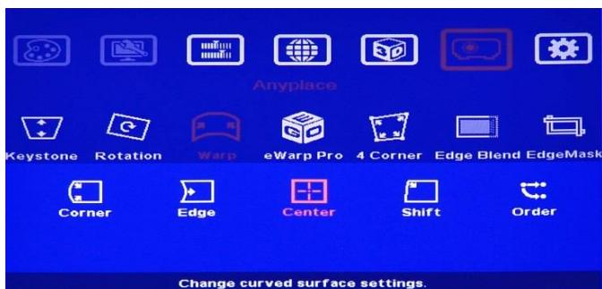
中心軸を垂直に±256ピクセル、水平に±200ピクセル単位でずらして調整が可能です。(解像度 1400x1050 以下の場合)
